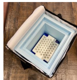
② ホルダーにバイアルをセットしZipLocに入れて封をする これを①の上に設置
