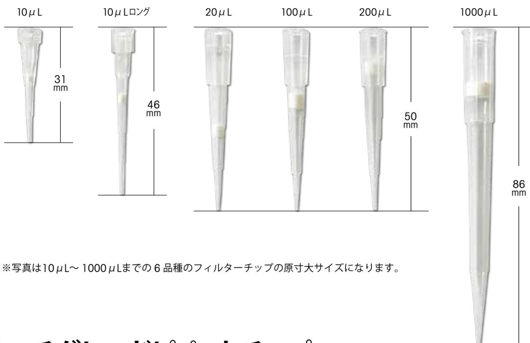
※写真は10 $\mu$ L~1000 $\mu$ Lまでの6品種のフィルターチップの原寸大サイズになります。
